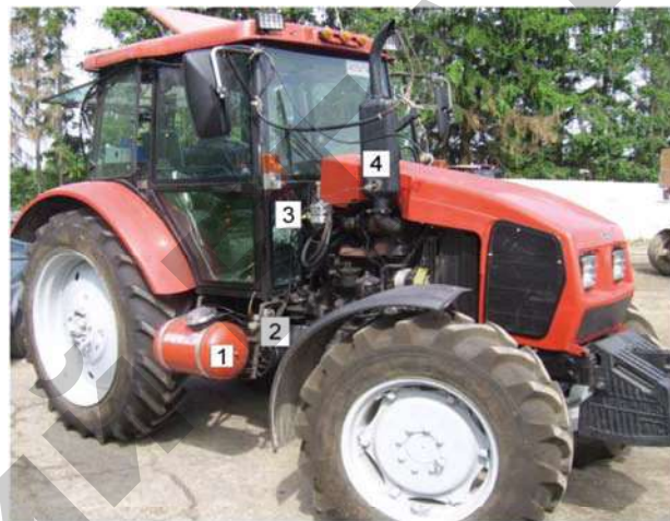
Рисунок 2. Трактор «Беларус-922» с системой подачи газа: 1 – газовый баллон; 2 – выносное заправочное устройство (ВЗУ); 3 – газовый редуктор; 4 – датчик температуры отработанных газов
