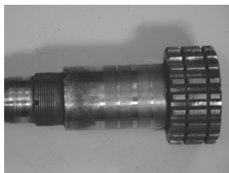
а – вал вторичный коробки перемены передач автомобиля КаМАЗ - 53212; б – вал первичный коробки перемены передач трактора К-701 Рисунок 1 – Фотографии изношенных посадочных поверхностей деталей автотракторной техники
