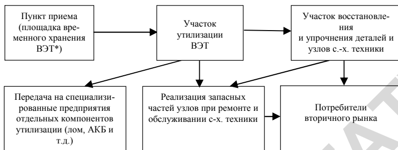
Рисунок 2 – Схема взаимодействия участков утилизации и восстановления деталей
