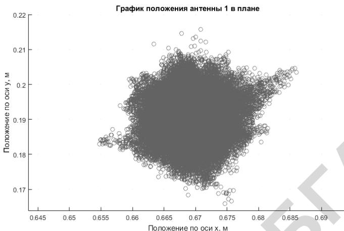
**Рисунок 3. График положения антенны 1 в плане**
