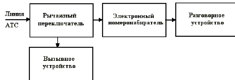
Рисунок 7.8 - Структурная схема электронного ТА (с кнопочным номеронабирателем)
