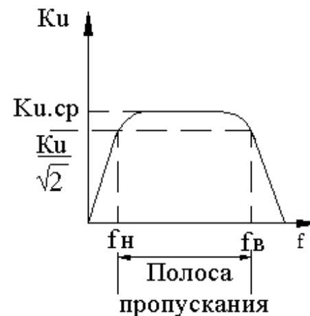
Рисунок 3.5 – Амплитудно-частотная характеристика УК
