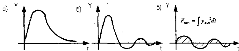
Рис. 2.99 Характеристики типовых переходных процессов: a – аperiodический; б – с 20%-ным перерегулированием; в – с минимальной площадью под кривой переходного процесса
