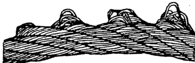
Рисунок П.11 Выдавливание проволок прядей: а – в одной пряди; б – в нескольких прядях
