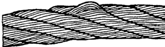
Рисунок П.10 Выдавливание сердечника
