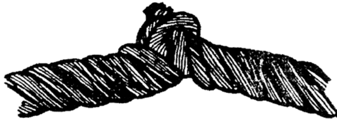
Рисунок П.14 Перекручивание каната
