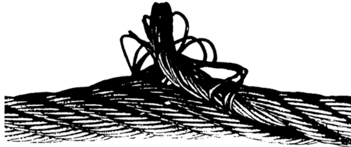
Рисунок П.10 Выдавливание сердечника
