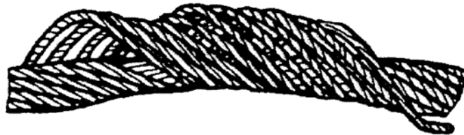
Рисунок П.9 Корзинообразная деформация
