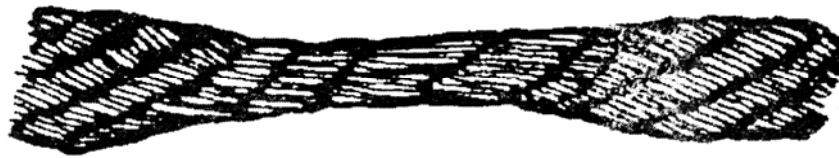
Рисунок П.13 Раздавливание каната
