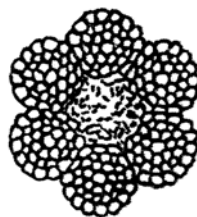
Рисунок П.7 Уменьшение площади поперечного сечения проволок (интенсивная внутренняя коррозия)
