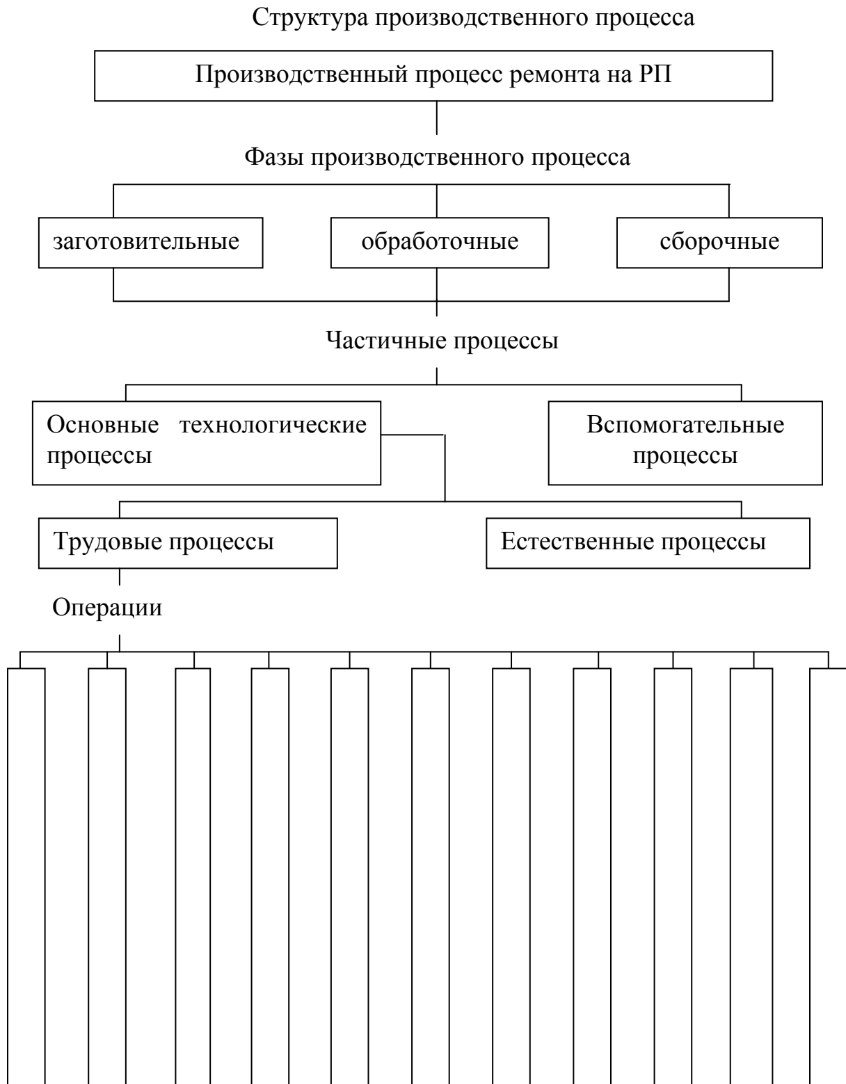
Рис. 1.1 Структура производственного процесса на ремонтном предприятии
