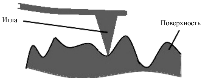
Рис. 3. Схема измерения шероховатости поверхности контактным методом
