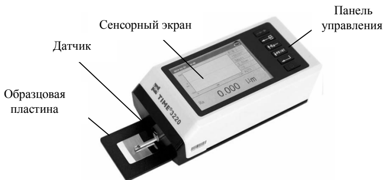
Рис. 4. Внешний вид профилометра-профилографа TIME 3220
