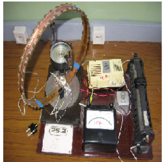
Рис. 5.24. Принципиальная схема и общий вид лабораторной установки. \varepsilon - источник питания, mA – миллиамперметр, К – переключатель направления тока в витках, ТГ – витки тангенс-гальванометра, ПМ – переключатель для выбора количества витков, R – реостат.
