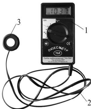
Рис. 5.3. Общий вид люксметра ТКА-ПКМ/31:
