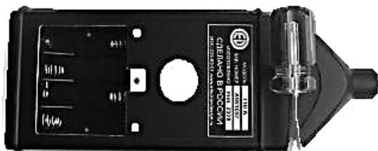
Рис. 7.2. Задняя панель прибора «Октава-110А»
