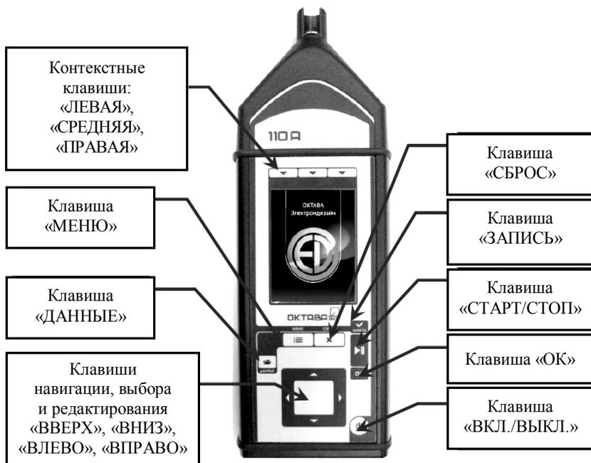
Рис. 7.4. Назначение клавиш прибора «Октава-110А»
