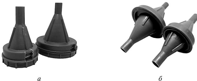
Рис. 3.5. Фильтродержатели ИРА открытого (*а*) и закрытого (*б*) типа
