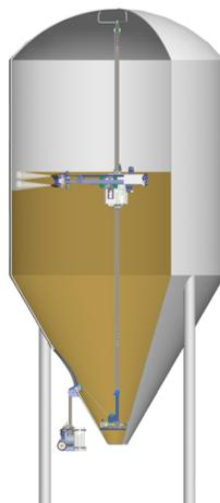
Рисунок 1 – Передвижной пункт с роботизированным манипулятором и гидравлической мойкой высокого давления (компания Silo-RoBoFox, Германия)
