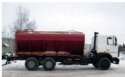
Загрузчик сухих кормов ЗСК-Ф-15-08 на базе МАЗ-6303
