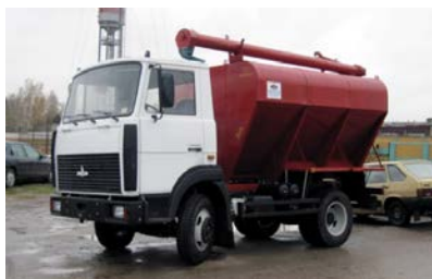
Загрузчик сухих кормов ЗСК-Ф-10А-03 на шасси МАЗ-457043
