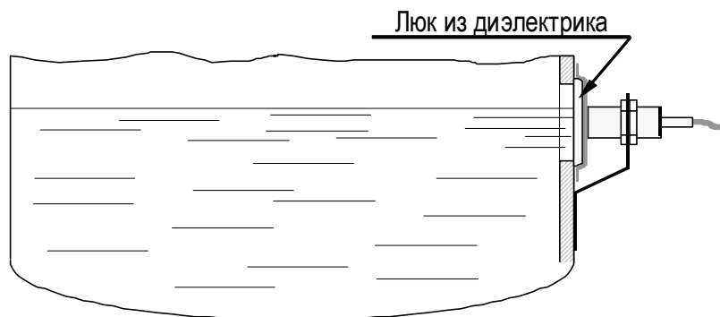
Рисунок 7 – Пример монтажа выключателей для контроля уровня жидкости
