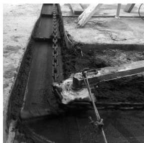
Рис. 15.5. Натяжное устройство скребкового транспортера ТСН-160А: 1 – поворотная звездочка; 2 – натяжной ролик; 3 – рычаг натяжного ролика; 4 – стойка; 5 – трос подвески груза; 6 – груз
