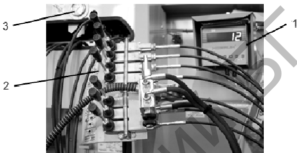
Рис. 11.7. Пульт дистанционного управления: 1 – дисплей весового механизма; 2 – клавиатура управления; 3 – манометр
