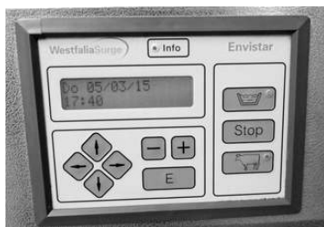
Рис. 17.3. Схема (а) и общий вид (б) панели управления автомата промывки
