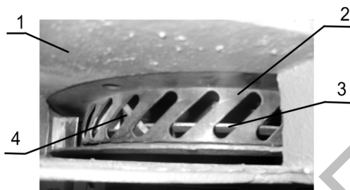
Рис. 4.4. Дека: 1 – корпус; 2 – дека; 3 – диск; 4 – нож
