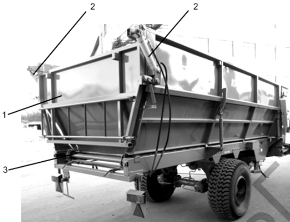
Рис. 10.3. Кузов с шарнирно подвешенным задним бортом: 1 – задний борт; 2 – гидроцилиндры; 3 – продольный транспортер
