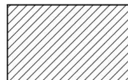
Рисунок 1.5 – Общее графическое обозначение материала
