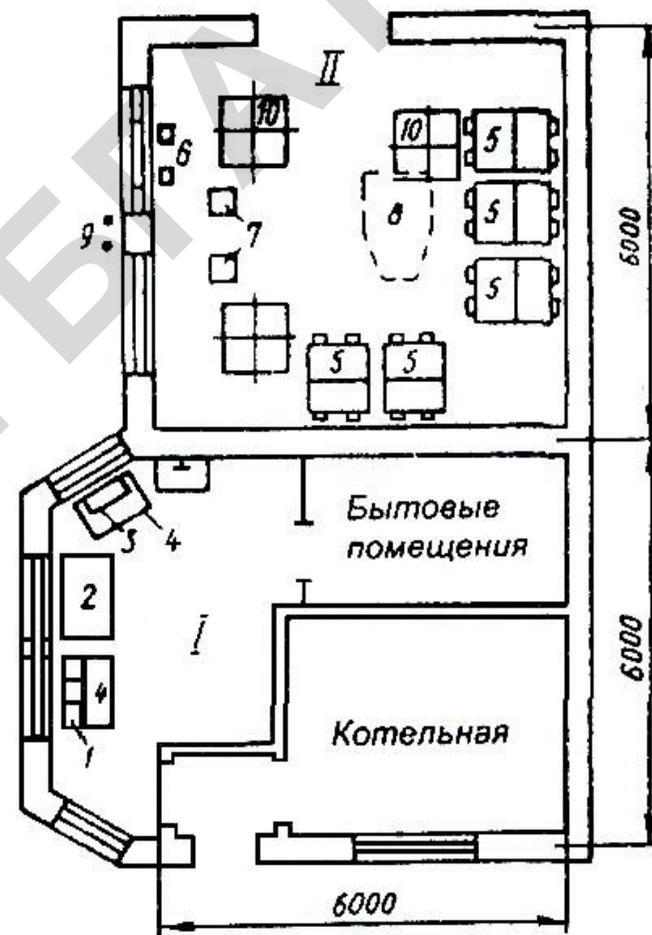
Рисунок 10.1 – План операторской с маслоскладом и маслораздаточной (нефтесклады вместимостью 40, 80 и 150 м<sup>3</sup>):
