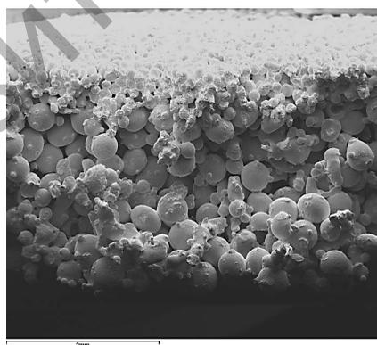
Рис. 3.18. Двухслойная структура ПФМ из сферического порошка оловянно-фосфористой бронзы
