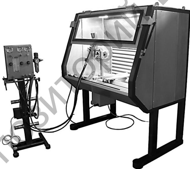
*Рис. 1.11.* Камера полу-автоматического напыления ТЕНА-КПАН-1300 с установкой газопламенного напыления ТЕНА-Ппм
