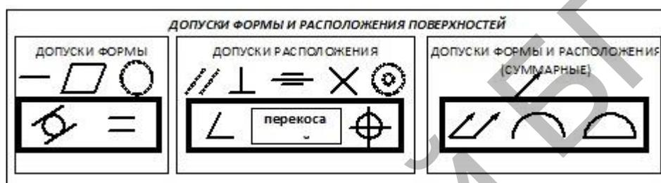
Рисунок 1 – Нормируемые общие допуски формы и расположения поверхностей и ненормируемые (в двойной рамке)
