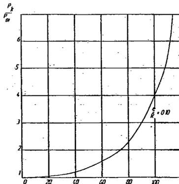
Рисунок 4. Изменение давления воздуха в ячейке по углу поворота ротора
