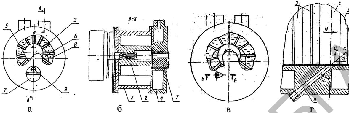
Рисунок 5. Способы активизации взаимодействия струи жидкости и лопатки
