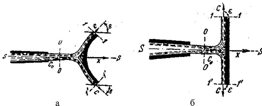
Рисунок 1. Схема активного взаимодействия струи жидкости и лопатки:
