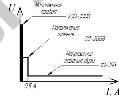
Рис. 1.32. Рабочие состояния газового разрядника
