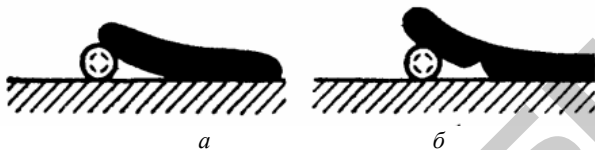
Рис. 3.1. Схема разрушения слоя загрязнения пульсирующими кавитационными пузырьками: а – начальный этап; б – момент разрушения
