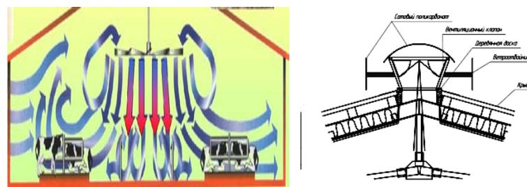
Рис. 1.10. Конструкция свето-вентиляционного фонаря «Farmtec» с регулируемым клапаном
