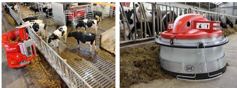
Рис. 1.13. Автоматизированная система раздачи и подкладки корма
