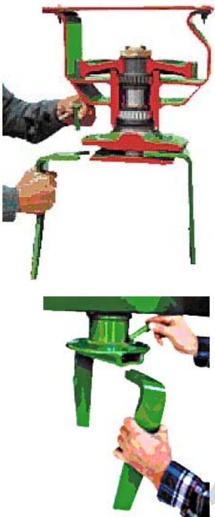
Рисунок 5.5 – Быстросменное приспособление для замены зубьев роторных рабочих органов
