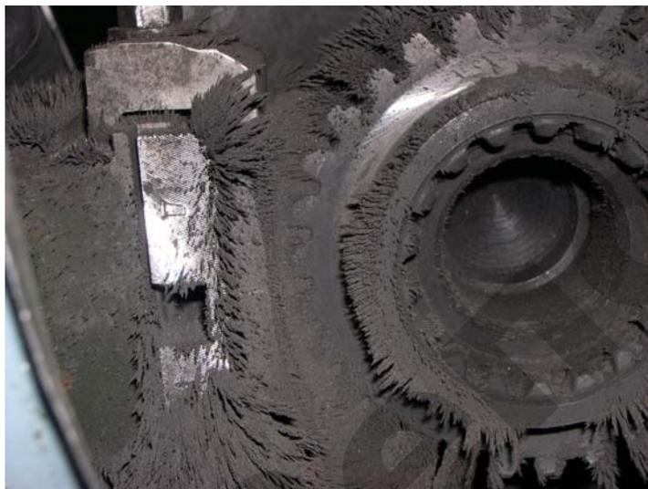
Рис. 4.7. Наполнение впадин зубчатого колеса ФАП в процессе МАО (вращение детали против часовой стрелки) (общий вид)
