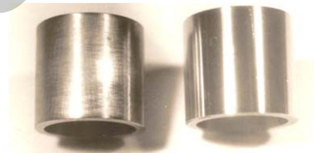
Рис. 2.24. Детали до (слева) и после (справа) обработки методом МАО с использованием СОТС СинХО-2М
