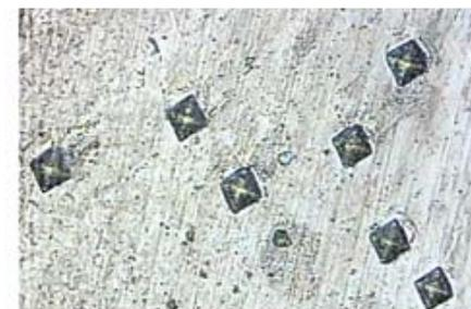
Рис. 4.1. Измерение микротвердости (увеличение  $\times 500$ )
