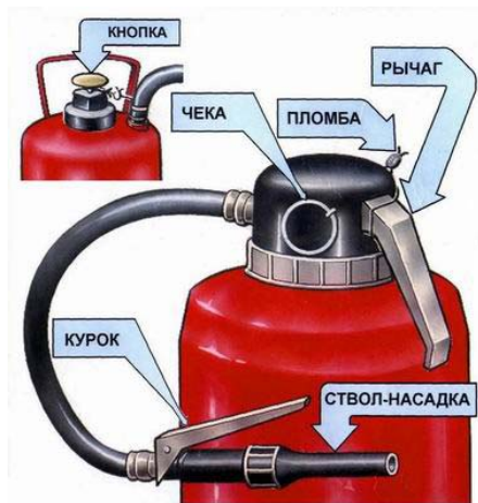
Рис. 7.7. Устройство порошкового огнетушителя с газогенерирующими устройствами
