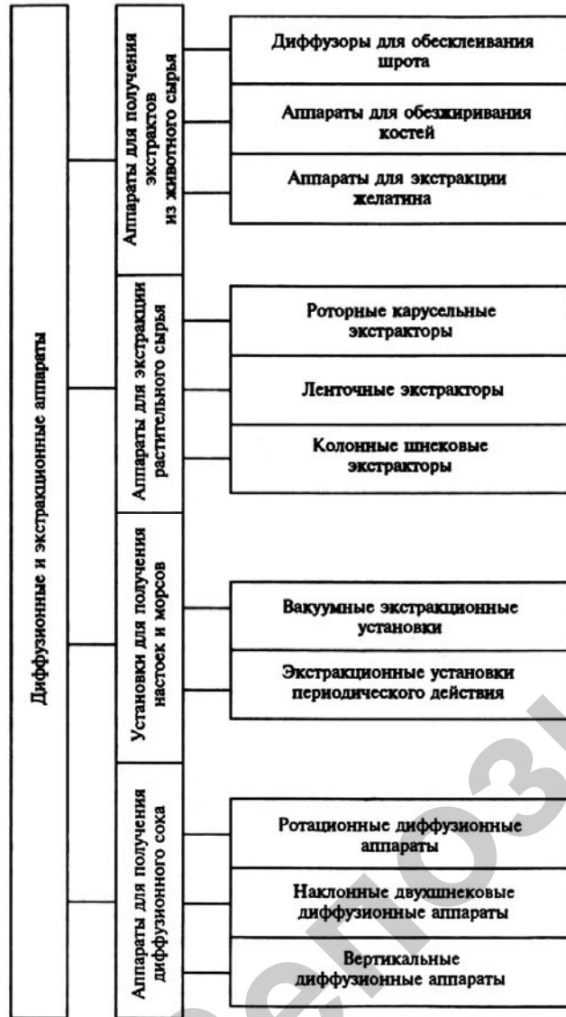
Классификация диффузионных и экстракционных аппаратов
