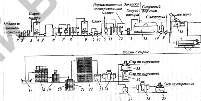
Рис. 11. Машинно-аппаратурная схема линии производства твердых сычужных сыров: 1, 5, 14 – насосы; 2 – фильтр; 3 – счетчик-расходомер; 4 – резервуар для хранения молока; 6 – пластинчатый теплообменник; 7 – сепаратор-молокоочиститель; 8 – пластинчатый охладитель; 9 – резервуар; 10 – уравнивательный бачок; 11 – сепаратор-нормализатор; 12 – секция рекуперации пастеризационно-охладительной установки; 13 – сыродельная ванна; 15 – формовочный аппарат; 16 – отделитель сыворотки; 17 – тележки для самопрессования; 18 – прессы; 19 – весы; 20 – контейнеры с сыром; 21 – посолочный этажер; 22 – передвижные стеллажи; 23 – машины для мойки сыра; 24 – машины для обсушивания сыра; 25 – парафинер; 26 – вакуумупаковочная машина; 27 – машины для нанесения латексного покрытия на сыр
