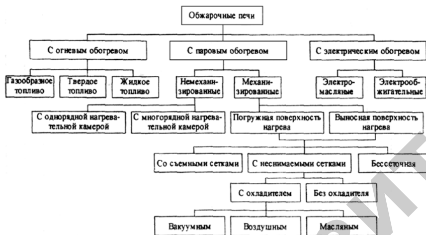
Рис. 27. Классификация обжарочных печей
