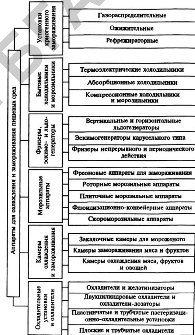
Классификация аппаратов для охлаждения и замораживания пищевых сред
