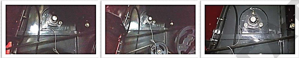
Рис. 2. Датчики, установленные в точке 1, для измерения ускорения в направлениях Ox , Oy и Oz соответственно
