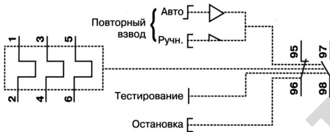
Рисунок 1.25 – Электрическая схема РТИ
