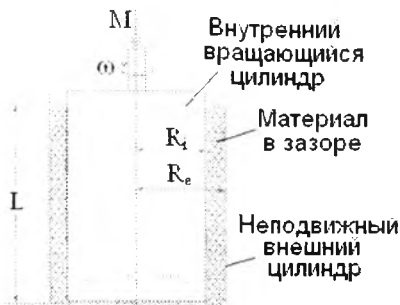
Рис. 2. Схема ротационного вискозиметра с вращающимися цилиндрами
