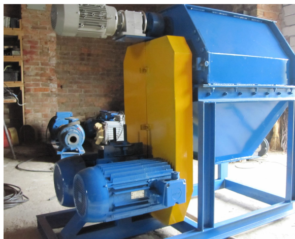
Рис. 1. Схема конструкции и общий вид разработанной вальцовой дробилки зернофуража
