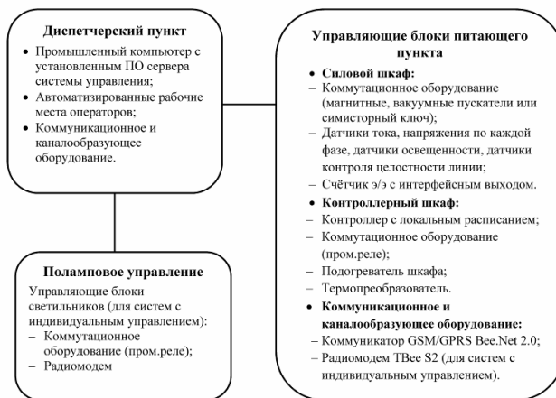
Рисунок 1 – Состав автоматизированной системы управления наружным освещением (АСУНО)
