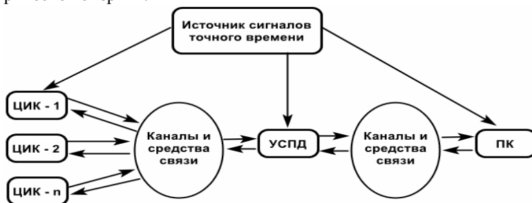
Рис 1. Структурная схема цифровой АСКУЭ с анализом ПКЭ.
