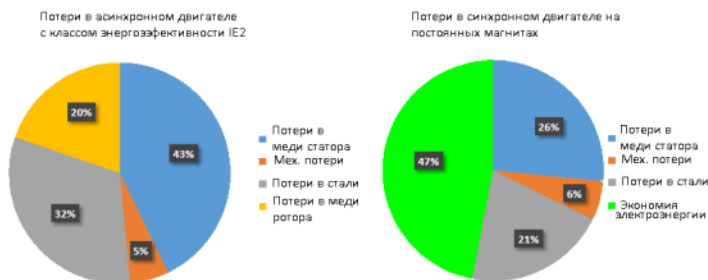
Рисунок 1. Распределение потерь в трехфазном асинхронном двигателе и в синхронном двигателе на постоянных магнитах.
