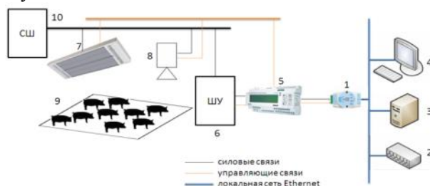
Рисунок 2 – Структурная схема системы управления ИК облучением по поведению животных
