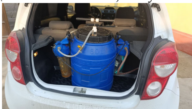
Рисунок. Установка для производства водородного биогаза на автомобиле «Спарк»
