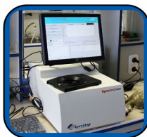
Прибор NIRS для анализа кормов в режиме реального времени
