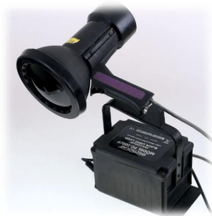
Рисунок 1 – Ультрафиолетовая лампа для обнаружения утечек за счет свечения индикаторного газа в ее лучах (модель Spectroline FC 100)
