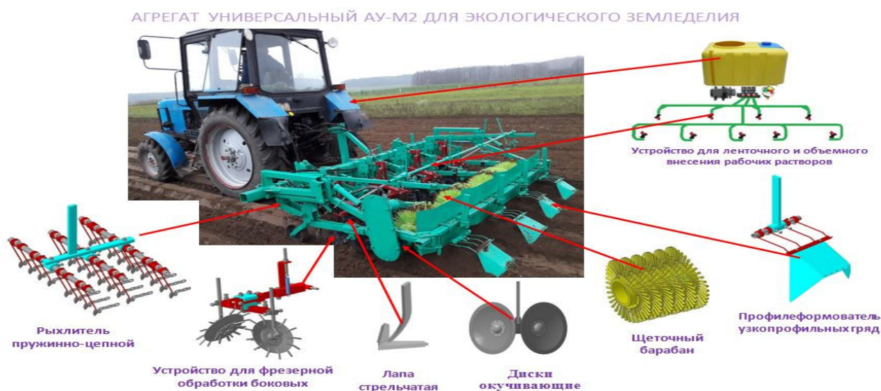
Рисунок 1. – Агрегат комбинированный универсальный АУ-М2 с набором рабочих органов
