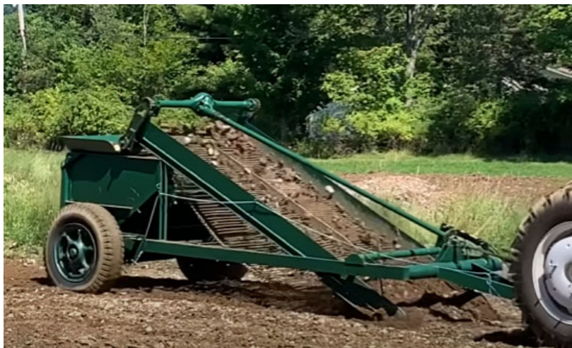
Рисунок 2 – Машина для сбора камней с цепочно-планчатým транспортером и накопительным бункером
