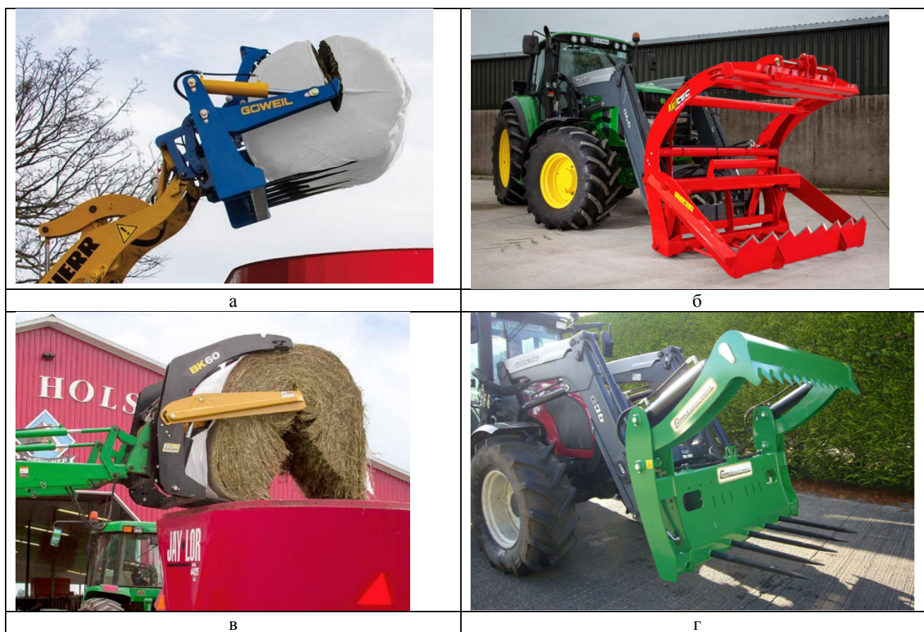
а – RBS («GOWEIL» (Австрия); б – KT-44 («Keltec Engineering» (Ирландия); в – BK-60 («HLA Attachments» (Канада); г – 5FT («Cashels Engineering Ltd» (Ирландия) Рисунок 1 – Резчики запрессованных травяных кормов
