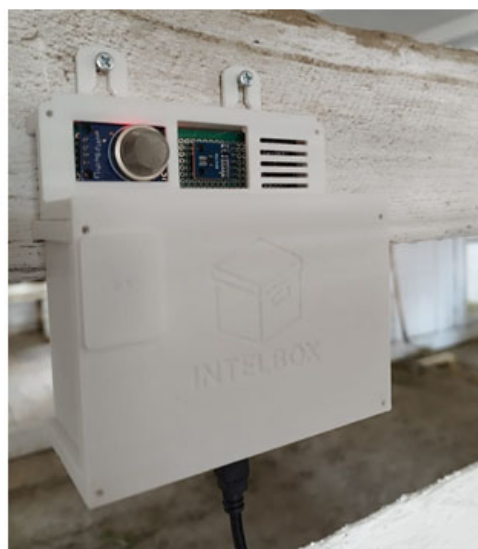
Рисунок 1 – Внешний вид и компоненты прототипа цифровой системы диагностики микроклимата животноводческих помещений
