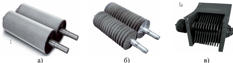
Рисунок 1 – Виды доизмельчающих устройств кормоуборочных комбайнов: а) вальцовые; б) дисковые; в) роторные
