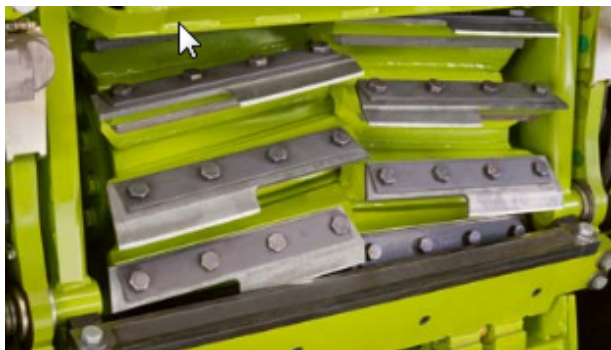
Рисунок 3 – Полуножи установленные на измельчающем барабане V20
