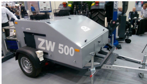
Рисунок 1 – Передвижной тормозной стенд ZW 500 с вихретоковым тормозом
