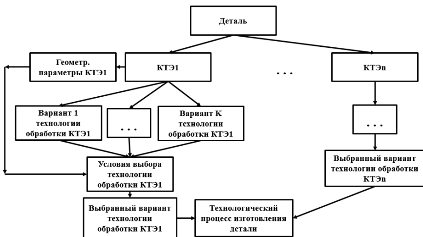
Рисунок 3 – Схема формирования технологического процесса изготовления детали методом структурного синтеза
