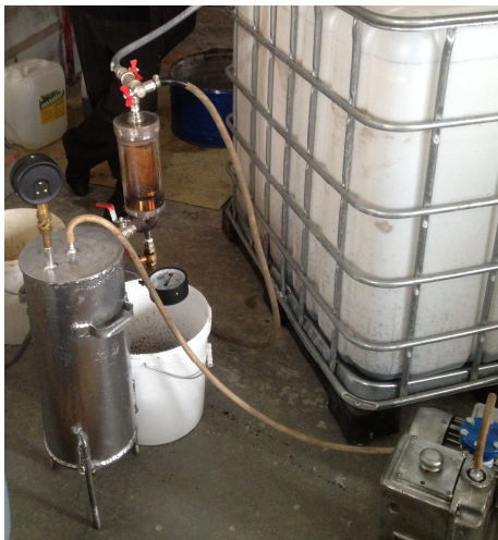
Рисунок 2 – Испытания опытного образца устройства для очистки суспензии гидрогумата торфа
