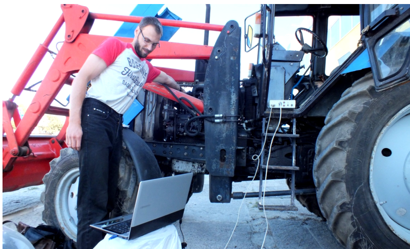
Рисунок 3 – Инженер Кирдишев Д.В. производит измерение вибрации на форсунках дизельного двигателя Д-243
