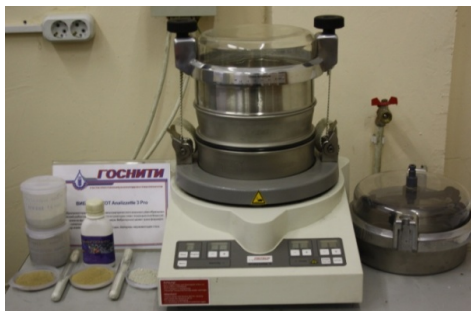
Рисунок 1 – Фракционирование порошков на виброгрохоте «Analizzate-3 Pro»; порошок слева – исходный, в центре – обработанный, он стал светлее; справа порошок «ИКСАР»; в пробирках трибосостава «Сарановский», РВД; в баночках – порошки ГМТ из Грузии
