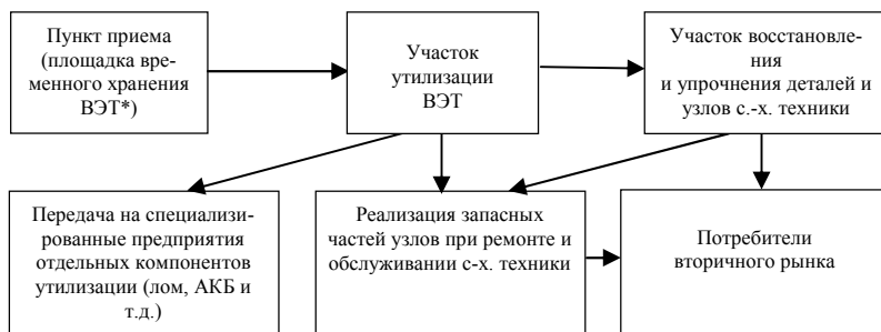
Рисунок 2 – Схема взаимодействия участков утилизации и восстановления деталей
