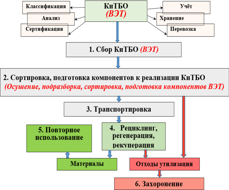
Рисунок 2 – Общая схема обращения с отходами производства и потребления применительно к ВЭТ и КиТБО
