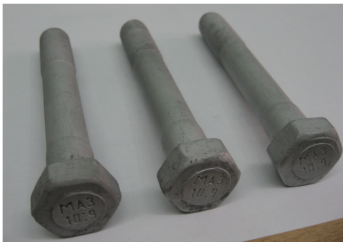
Рисунок 2 – Крепежные элементы, обработанные по технологии совместной термической и антикоррозионной обработки
