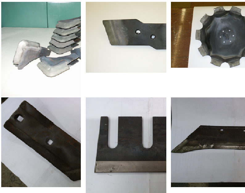
Рисунок 1 – Детали сельскохозяйственной техники с рабочими зонами, восстановленными методом газопорошковой наплавки
