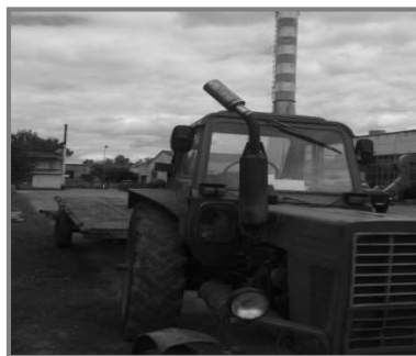
Рисунок 3 – Искрогаситель (выхлопная система МТЗ-80)
