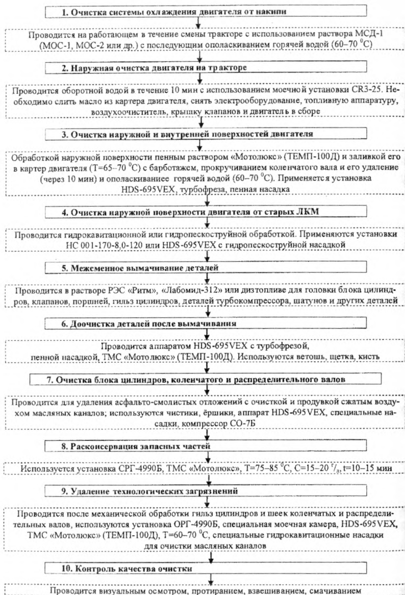
Рисунок – Схема технологического процесса очистки автотракторных двигателей и их деталей при ремонте
