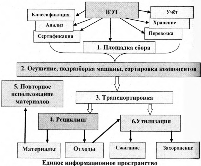
Рисунок 2 – Структура работ, проводимых в технологической подсистеме
