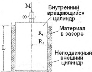
Рис. 5. Схема ротационного вискозиметра с вращающимися цилиндрами
