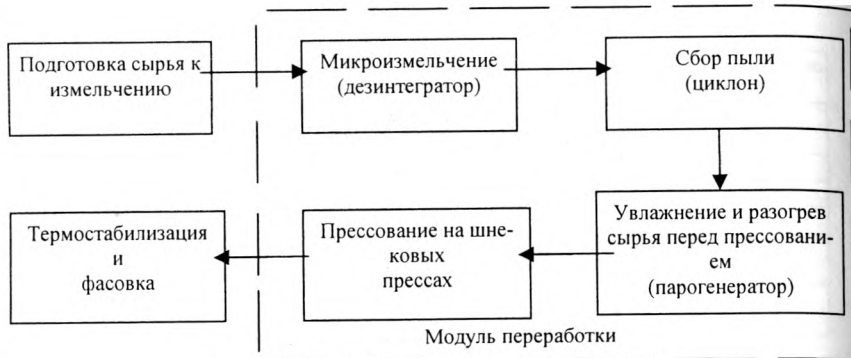
Рис. 2. Структурная схема увлажненного прессования
