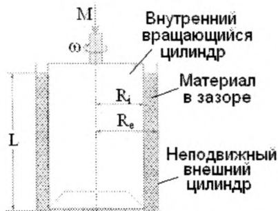
Рис. 2. Схема ротационного вискозиметра с вращающимися цилиндрами
