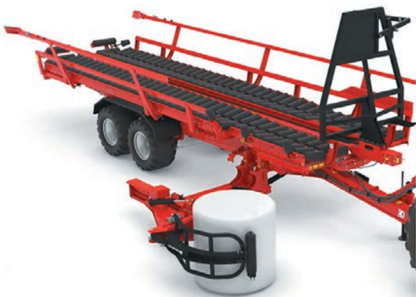
Рисунок 4 – Этап захвата рулона в вертикальном положении автоматизированным захватывающим устройством
