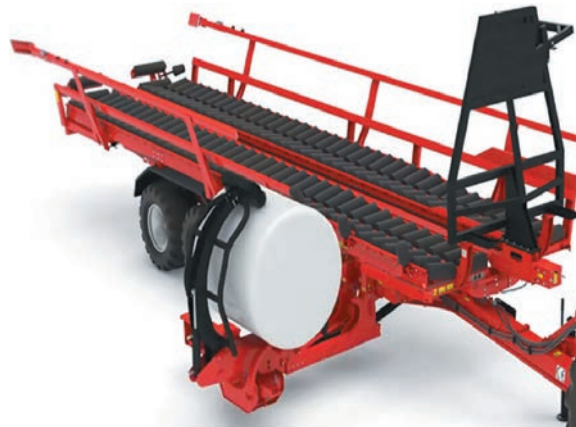
Рисунок 5 – Этап подъема рулона и опрокидывания его в вертикальном положении на 90^\circ автоматизированным захватывающим устройством
