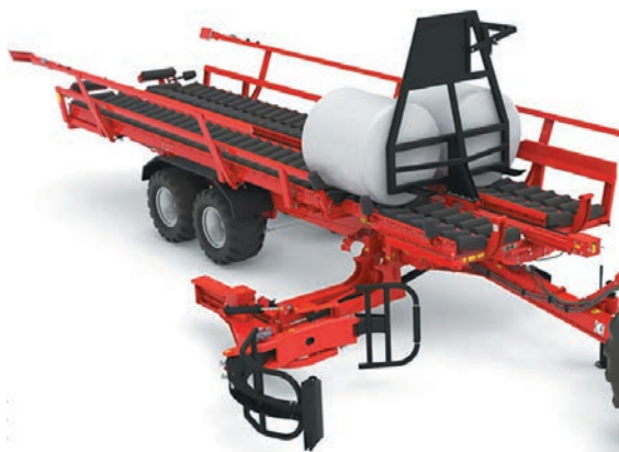
Рисунок 7 – Этап перемещения рулонов по платформе толкающей стенкой
