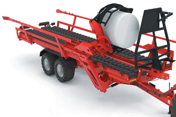
Рисунок 6 – Этап загрузки рулона, расположенного вертикально, на платформу погрузочным рычагом
