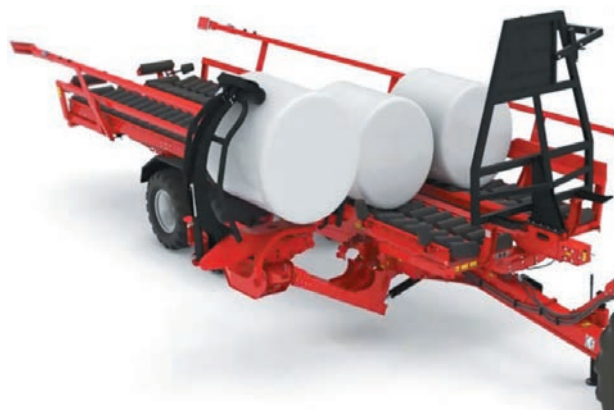
Рисунок 10 – Этап поворота рулона в горизонтальном положении на 90°
