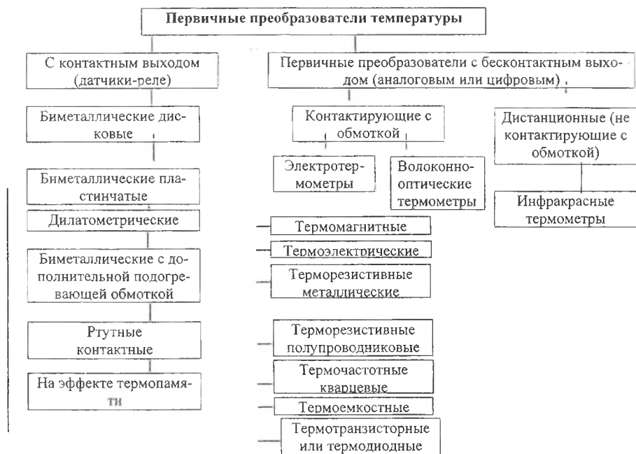
Рисунок 1. Классификация первичных преобразователей температуры
