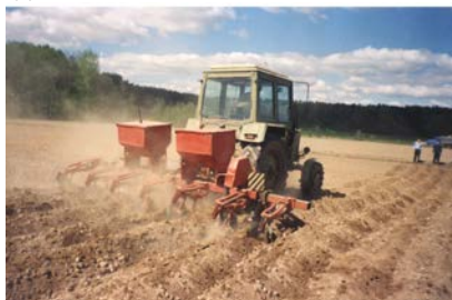
Рисунок — Универсальная почвообрабатывающая машина-гребнеобразователь УПГ-2,8
