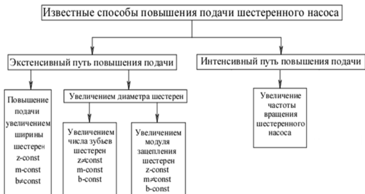
Рисунок 1 — Классификация известных способов повышения подачи шестеренного насоса
