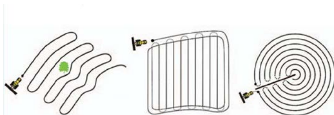
Рисунок – Возможность запоминать не только конечные и начальные точки ряда, но и любую кривую в качестве опорной линии позволяет реализовать самые разные варианты обработки полей
