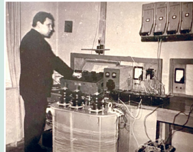
Генрих Иосифович за работой на установке по исследованию трансформатора с симметрирующим устройством.
