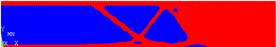
Рисунок 2 – Рекомендуемая форма конструкции, полученная после топологической оптимизации
