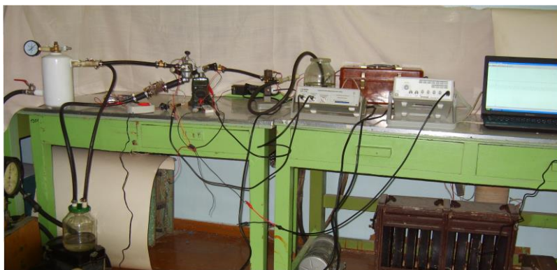
Рисунок 3 – Схема экспериментальной установки для получения расходной характеристики ( P'_м = \varphi(f) ) регулятора вакуума
