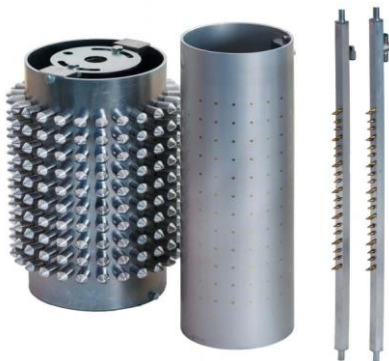
Рисунок 1 – Рабочие органы барабанно-вакуумного высевающего аппарата:
