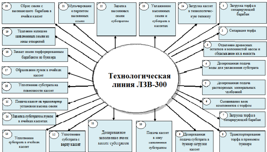
Рис. 3 – Функции линии технологической для заполнения кассет субстратом и высева семян ЛЗВ -300
