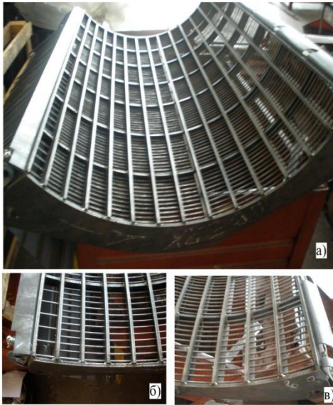
а – общий вид подбарабана с дифференцированной рабочей поверхностью; б – выходная зона подбарабана; в – входная зона подбарабана.
