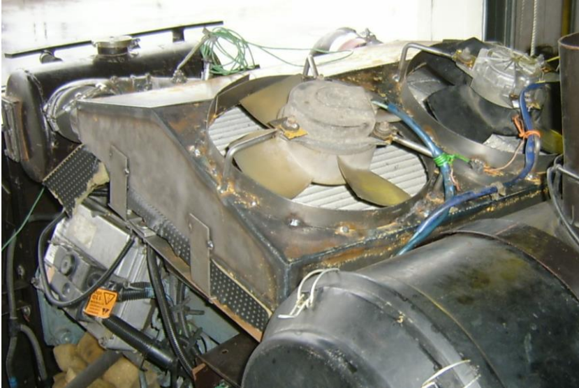
Рисунок 3 – Макет установки радиаторов ОНВ и кондиционера над дизелем на тракторе «БЕЛАРУС-3022ДВ» (вид сверху)
