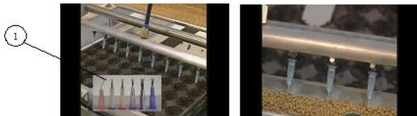
Рисунок 4. Общий вид игольчатого манипулятора для высева семян и набора сменных рабочих органов (1)
