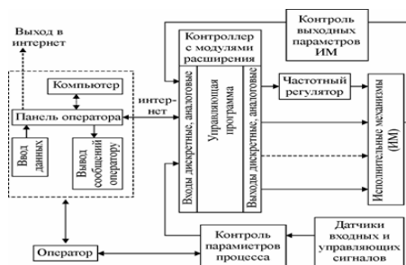
Рисунок 1. Функциональная схема микропроцессорной системы управления линией экструдирования зерна
