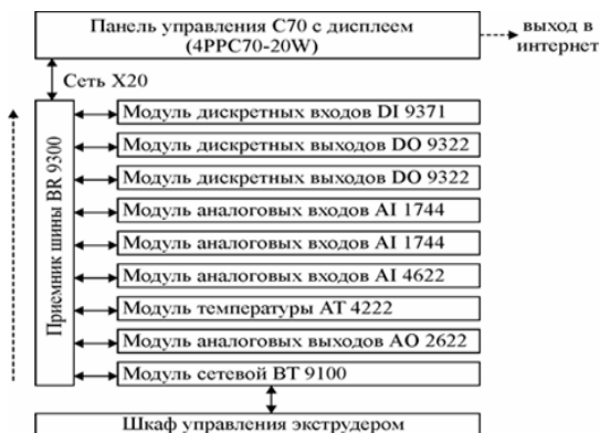
Рисунок 2. Комплекс технических средств микропроцессорной системы управления технологическим процессом
