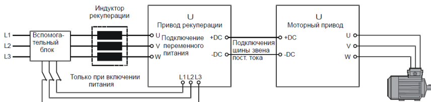
Рис.2. Вариант конфигурация привода: один- рекуперации, один – моторный
