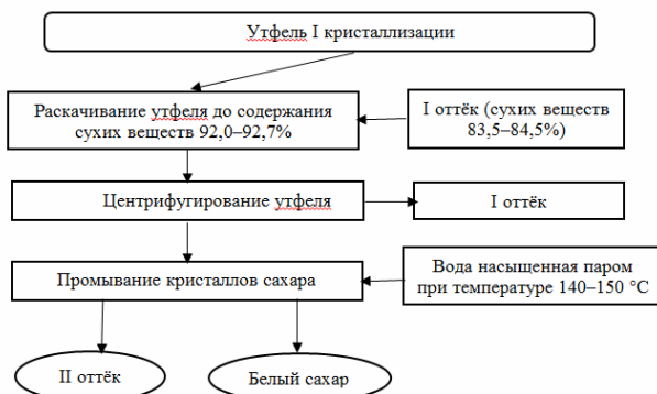
Рисунок 1 – Способ разделения утфеля первой кристаллизации в фильтрующей центрифуге периодического действия
