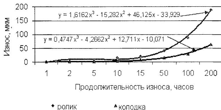
Рисунок 1 – Зависимость износа металлополимерных пар трения (ролик с покрытием из пористой полиамидно-эпоксидной композиции и колодки, изготовленной из незакаленной углеродистой стали) от продолжительности работы при следующих условиях: нагрузка p=1,5 МПа, скорость вращения v_r = 0,63 мс -1 ; граничное трение (смазка Литол 24); шероховатость контактирующих поверхностей – ролика Ra=12,5 мкм; колодки – 6,3 мкм
